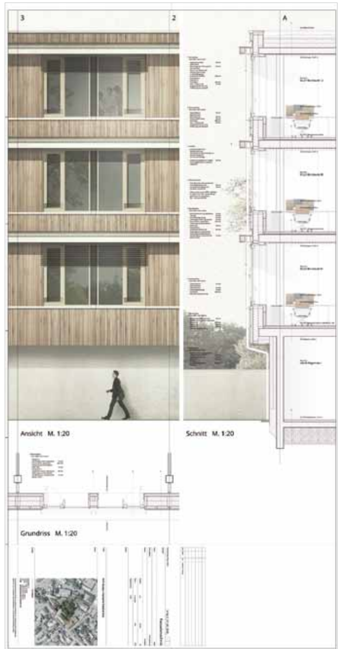
Fassadenschnitt eines Passivhauses für Finanzamt Waldmünchen (in SPIRIT erstellt)
